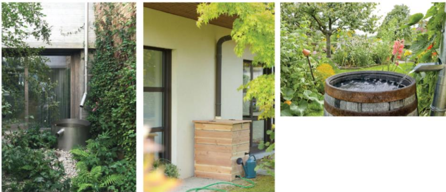
Cuves de récupération des eaux pluviales
